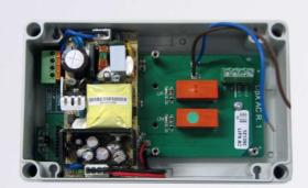
Flex1 ACDC come alimentazione per motori con dispositivo proprio di protezione da sovraccarico. (Azionamento a catena & a cremagliera) Dimensioni della confezione (L x P x A): 180 x 110 x 63 mm
