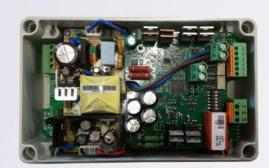
Flex1 ACDC come alimentazione per il protettore di sovraccarico es. LIP7 OC #121308 Dimensioni della scatola (Lx P x A): 180 x 110 x 63 mm
